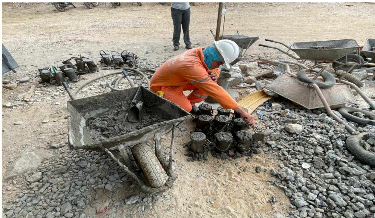
FOTO 128- Moldagem de corpos de prova na concretagem do redente da bacia de dissipação.
