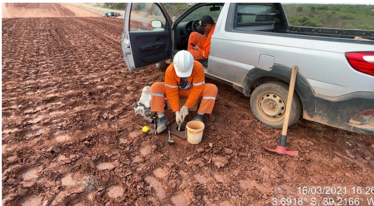
FOTO 67 – Ensaio de compactação – método Hilf
