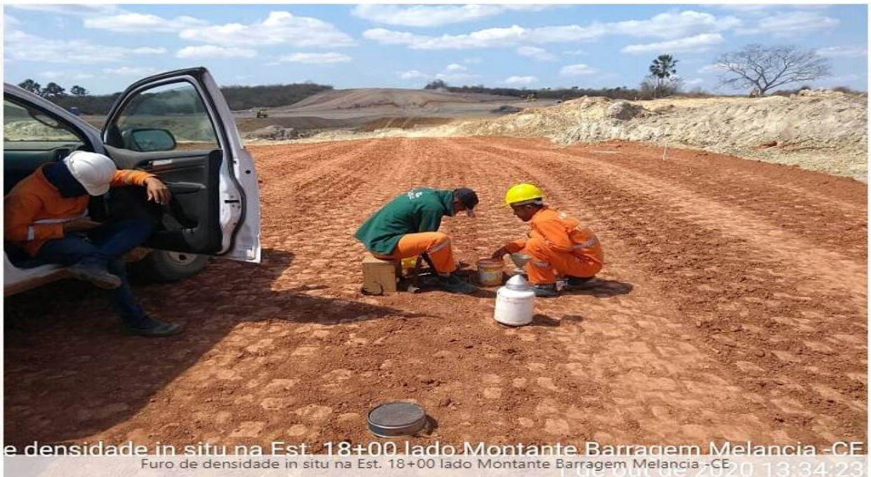
FOTO 08 – Ensaio de densidade 'in situ'. (Est.18)
